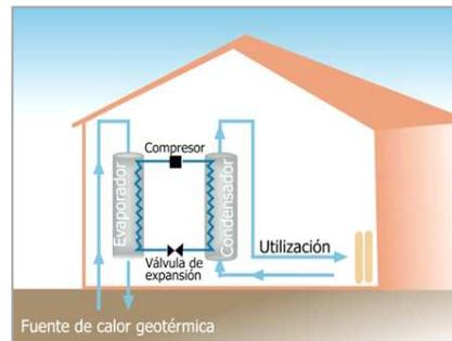
*Esquema de bomba de calor*
