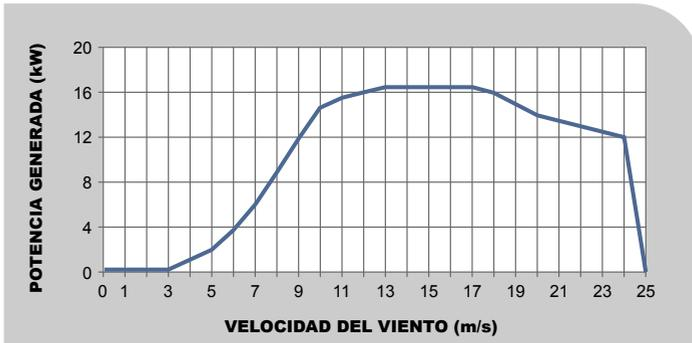
La curva de potencia de un aerogenerador nos indica a qué velocidad del viento produce el aerogenerador una potencia determinada.
