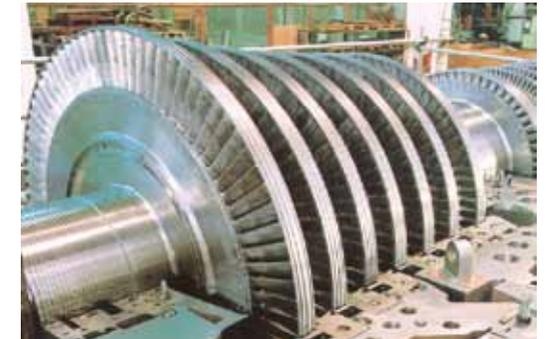
Vista de escalonamientos de turbina de vapor.
