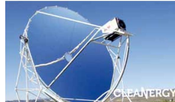
Aplicación del sistema Stirling para aprovechamiento de energía solar.
