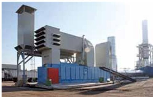
Turbina de gas para secado de orujo de aceituna.
