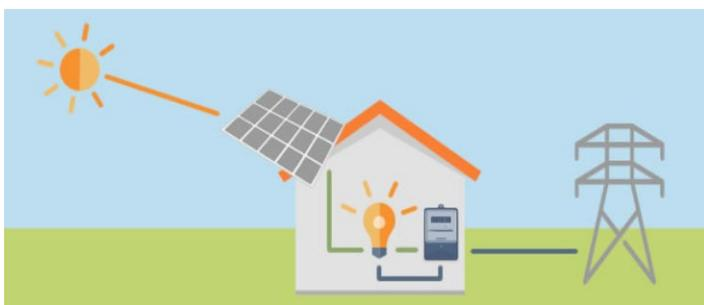
El autoconsumo fotovoltaico consiste en producir electricidad para el propio consumo a través de paneles solares fotovoltaicos que capturan la energía solar y la convierten en electricidad.
