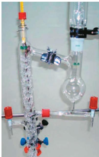
→ Detalle de montaje para el estudio en laboratorio de Reacción Bunsen.
