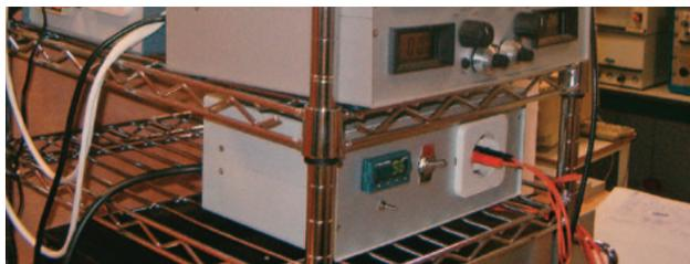
En este novedoso sistema, que ya ha arrojado resultados esperanzadores sobre su comportamiento en los primeros ensayos, presenta una alternativa al reformado catalítico convencional, que permite reformar mediante plasma el hidrocarburo o alcohol si necesidad de oxígeno. Si se emplea gas natural como alimentación originaría como productos hidrógeno y carbono en estado sólido.
